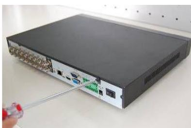
Remova os parafusos do seu gravador com uma chave.
