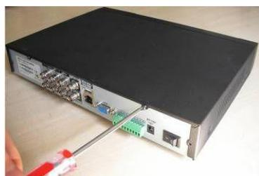
Feche o equipamento com parafusos
